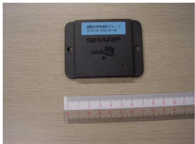
写真2 使用した無線タグ (仕様上は1~3m離れても読み取りができる長距離タイプ)
