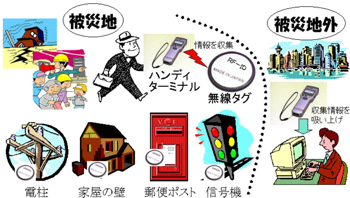
図1 無線タグを用いた非常時情報伝送システムのイメージ
