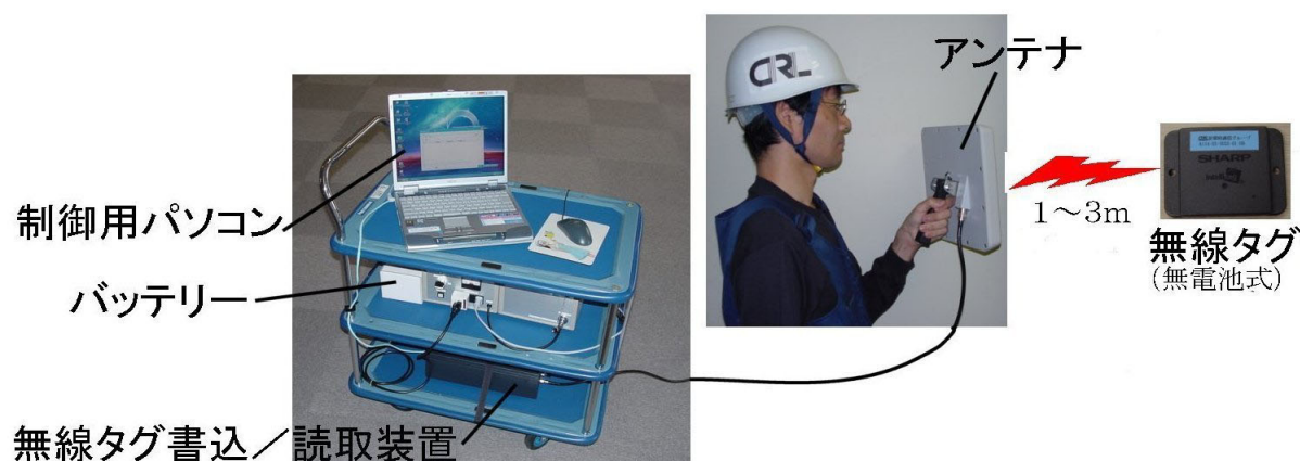
図2 無線タグを用いた非常時情報伝送システム
