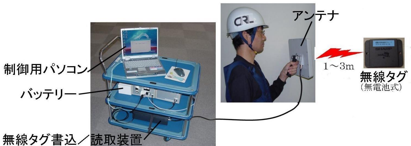
Fig.2 2001年度に開発した被災地情報収集システムの外観 Prototype system. (since FY2001)
