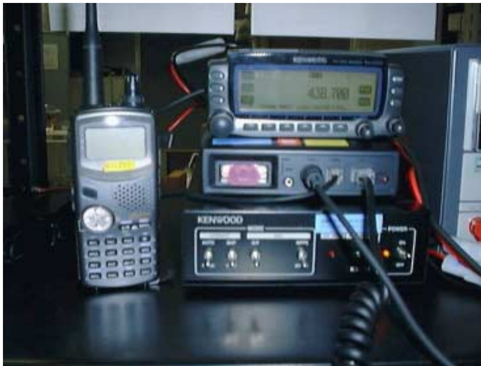
図4 アマチュア無線機による安否情報登録実験システムの外観 被災地移動局用ハンディ無線機(左)と、基地局無線機(右上)およびテレホンインタフェース(右下)
